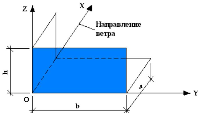
**Черт. 3. Основная система координат при определении коэффициента корреляции  $v$**
